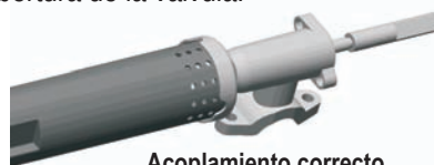
Acoplamiento correcto del quemador con la válvula
